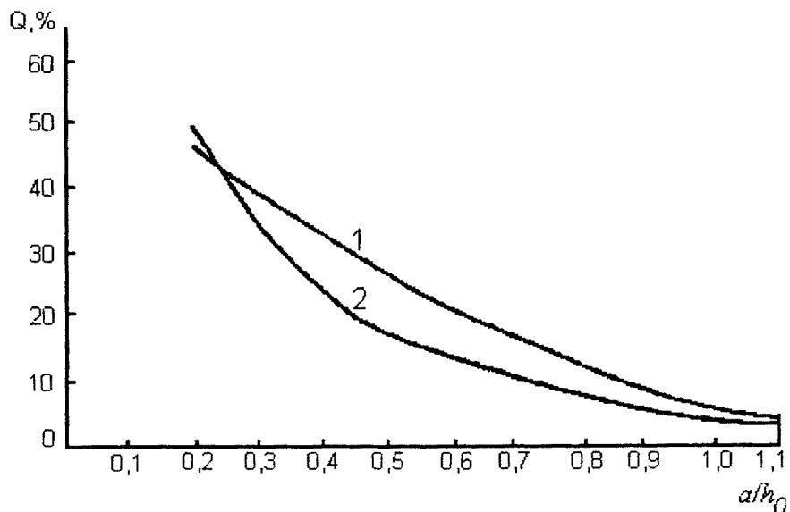
Рис. П3.3. Зависимость доли перелившейся через обвалование жидкости  $Q$  от параметра  $a/h$  : 1 - расчет; 2 - эксперимент
